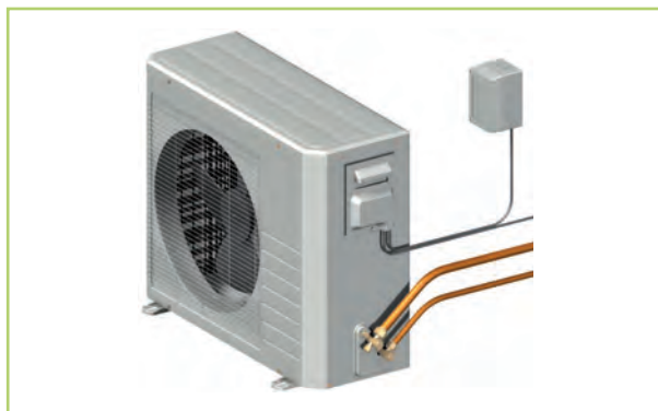
Obr. 43: Připojení vnější jednotky
